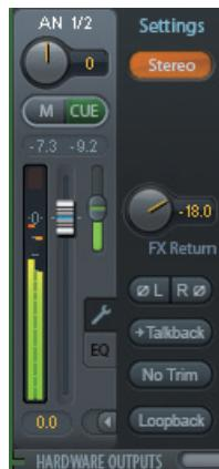
■ **No Trim**: 例えばライブ録音のステレオ・ミックスダウンなど、チャンネルのルーティングやレベルを固定して変更できなくしたいケースなどがあります。一例は、ライブ・ショーのレコーディングのステレオ・ミックスダウンです。No Trim を有効にすると、その出力へのルーティングは Trim Gains 機能から除外され、誤って変更されるのを防ぎます。
