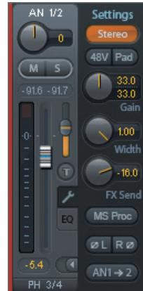
■ **AN1 → 2**: AN 1/2 入力ペアのステレオ・モード時にのみ利用できます。入力チャンネル 1 (Mic/Line 1) をチャンネル 2 にコピーします。良くある使用例：ステレオ録音時にマイク入力信号を LR から聞こえるようにしたい場合など。
