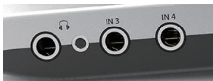
■ 出力チャンネル 3/4 : 2 つの個別のドライバー回路を介して 2 つの **Phones** 出力を供給し、高インピーダンス (TRS 1/4", 6.35mm) と低インピーダンス (TRS 1/8", 3.5mm) のヘッドフォンにそれぞれ最適化されています。これらのアンバランスの出力信号は、品質という点では XLR ライン出力のものと同一ですが、レベルは低くなります。
