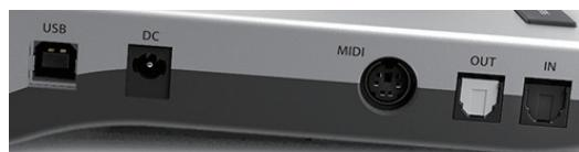
■ **オプティカル I/O (TOSLINK)**：本体は SPDIF または ADAT の入力信号を自動的に検知します。オプティカル出力は、*Settings* ダイアログ内の設定によって、ADAT または SPDIF 出力として動作します。
