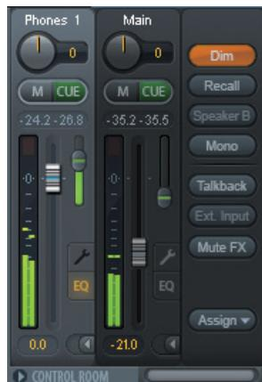
■ **Dim** : *Settings* ダイアログ (F3) で設定された量だけボリュームが抑制 (ディム) されます。
