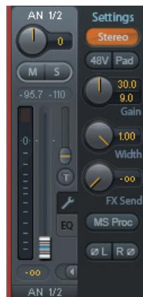
入力チャンネル 3 と 4 は Babyface Pro FS 本体の右側の TS 端子です。Hi-Z ユニバーサル入力の入力インピーダンスは 1 M Ω です。入力ゲインはデジタルでコントロールおよび実行され、9 dB に制限されています。追加のハードウェアベースのリファレンス・レベルで S/N 比を最適化します。選択肢は、+4 dBu および -10 dBV となります。
